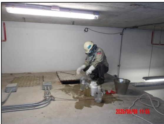
รูปที่ 3.7 การเก็บตัวอย่างคุณภาพน้ำทิ้ง บริเวณบ่อเก็บน้ำใสของระบบบำบัดน้ำเสียรวม
