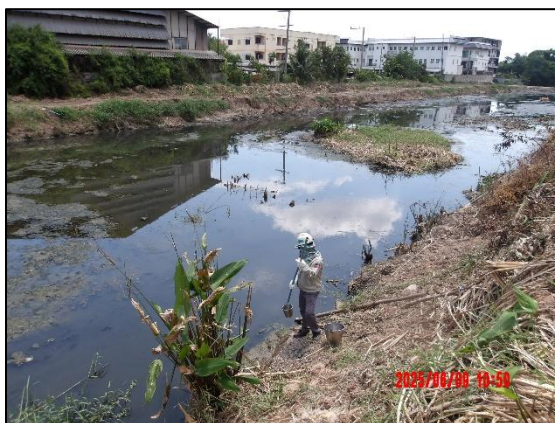
รูปที่ 3.4 การเก็บตัวอย่างคุณภาพน้ำผิวดิน บริเวณจุดหลังระบายน้ำ ระยะ 50 เมตร
